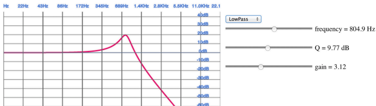
Рисунок 6-2. График частотной характеристики низкочастотного фильтра с параметрами
